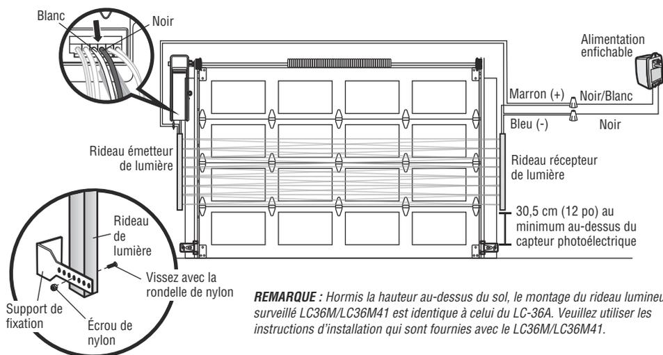
**REMARQUE :** Hormis la hauteur au-dessus du sol, le montage du rideau lumineux surveillé LC36M/LC36M41 est identique à celui de LC-36A. Veuillez utiliser les instructions d'installation qui sont fournies avec le LC36M/LC36M41.
